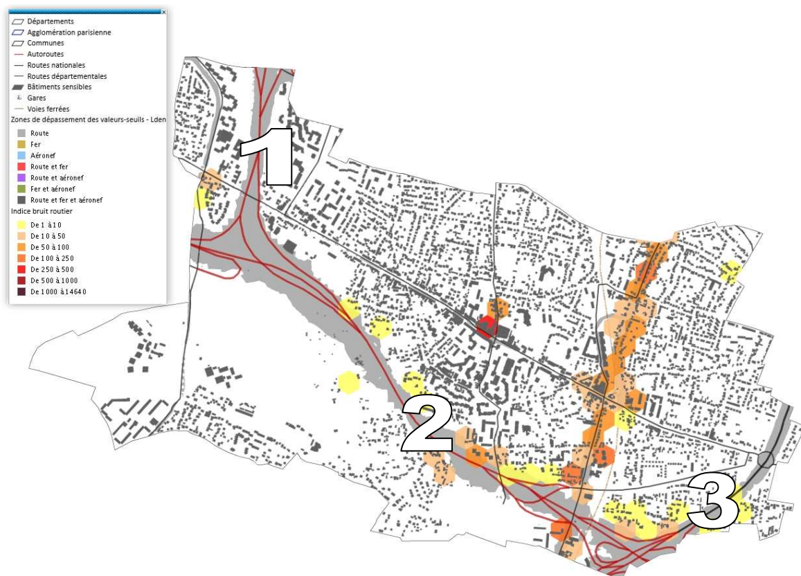
Synthèse des zones à enjeux par ordre de priorité pour l'ensemble des sources de bruit
